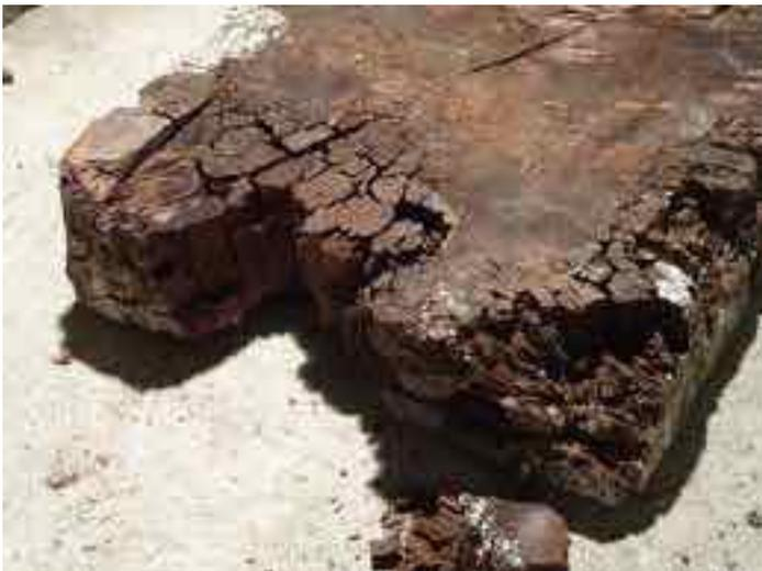
**Im unteren Bereich waren die beiden Holzsäulen unter der 1. Empore bereits stark verfault. Im Bild ein von einer Säule abgeschnittenes Stück**
