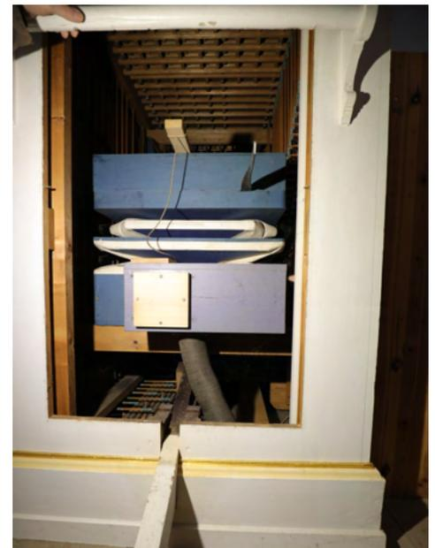
*Blasebalg. Tritt man auf den Holzbalken, der aus dem Orgelgehäuse herausragt, füllt sich der Balg mit Luft. Das dunkle flexible Rohr ist die neue Windkondukte zwischen dem Gebläse und dem Balg.*
