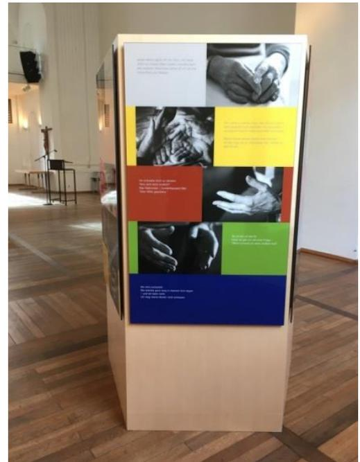
Die Stele ist 180x75cm und lässt sich komplett zerlegen (fünf Holzseitenteile a 170x75cm, fünf Holz-Sockel a 10x75cm und die fünf bedruckten Acrylglascheiben). Sie lässt sich in einem etwas größeren Mittelklassewagen (z.B. VW Golf Variant, o.ä.) transportieren.
