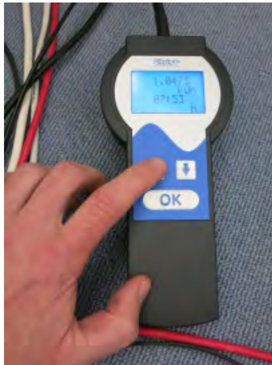
Wattmeter, Gerät zur Messung des Energieverbrauchs Foto: Thomas Keimerl, Caritas München Ost
