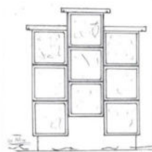
Urnengräber in Stelen-Fertigbauweise
