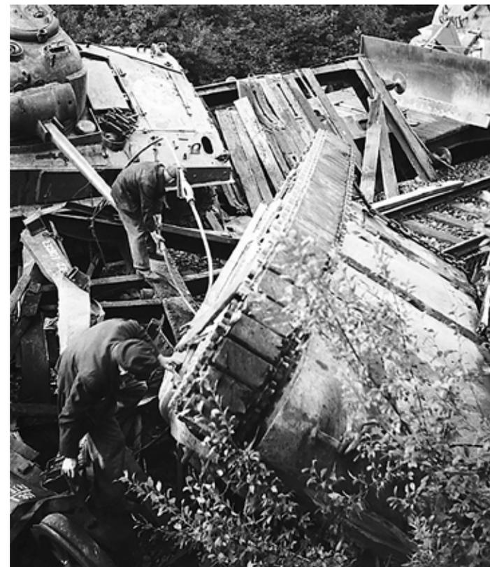
Abb. 3: Aus der Verankerung gerissener und umgestürzter Sherman-Panzer.
